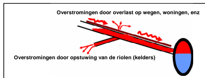
Fig. 18 : Schema van de gevolgen van de verzadiging van de collectoren.
